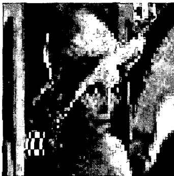
그림 12. 콘볼루션 부호적용 (인터리버 미사용) PSNR=26.4dB
