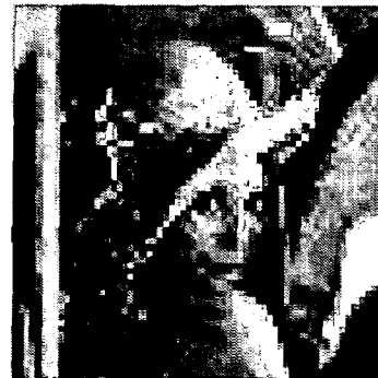
그림 11. 콘볼루션 부호적용 (인터리버 미사용) PSNR=29.7dB
