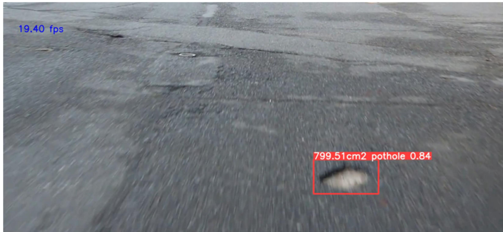
그림 43. 10km/h 에서 포트홀 검출 크기 측정
