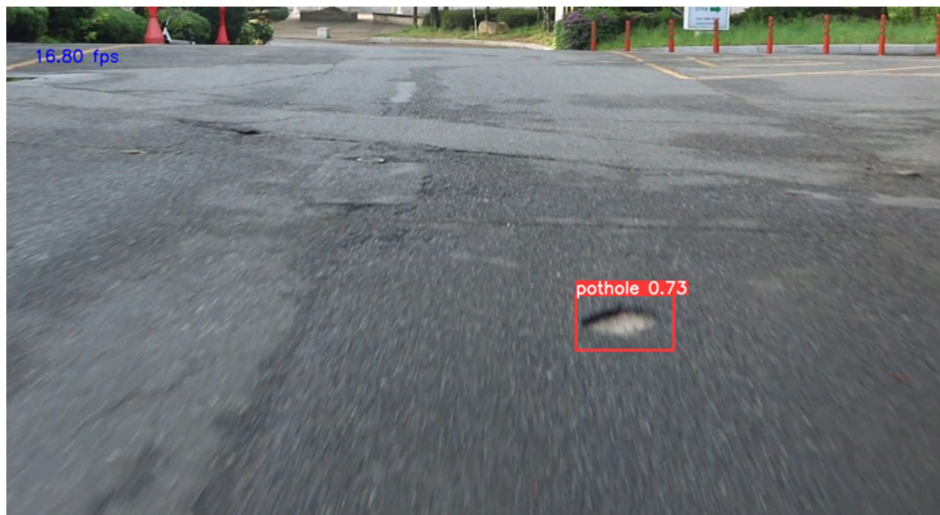
그림 34. YOLO v5를 이용하여 포트홀 검출
