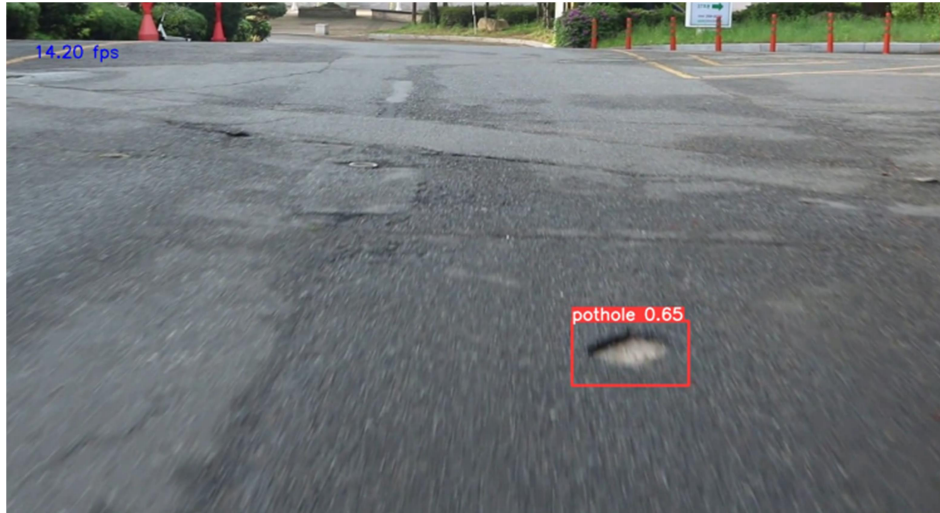
그림 33. YOLO v4를 이용하여 포트홀 검출
