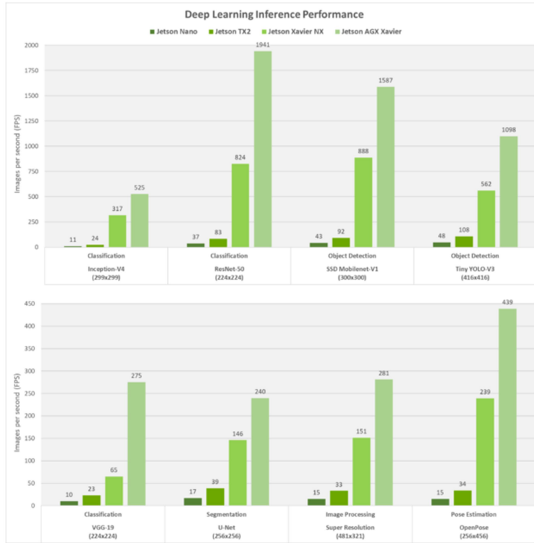
그림 13. Jetson NX, AGX Xavier TensorRT를 사용한 비전 기반 DNN 성능
