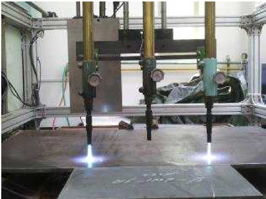
그림 46 두 개의 토치를 이용한 400mm 토치거리 실험
