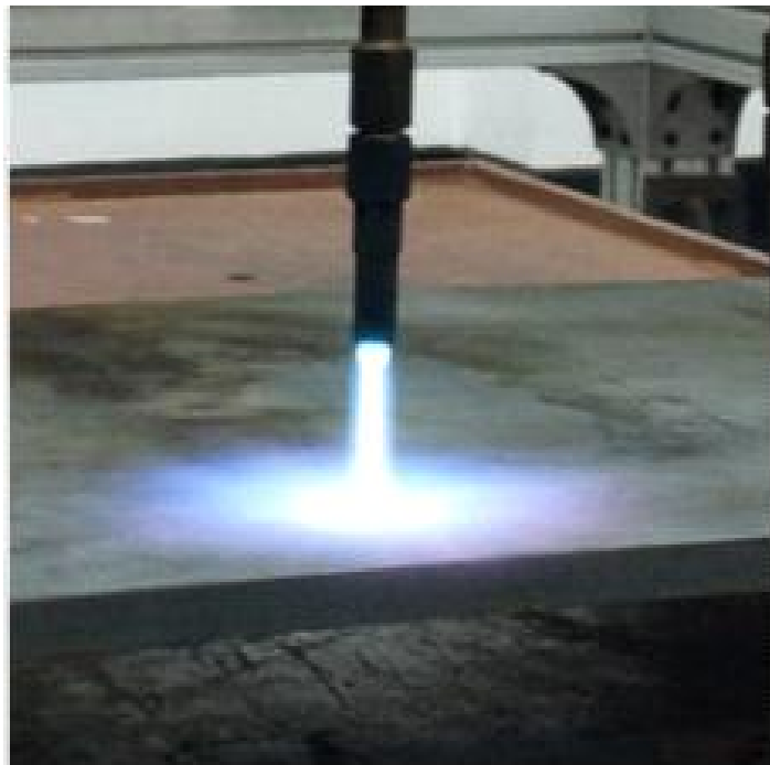
그림 11 싱글토치 선상가열 시험
