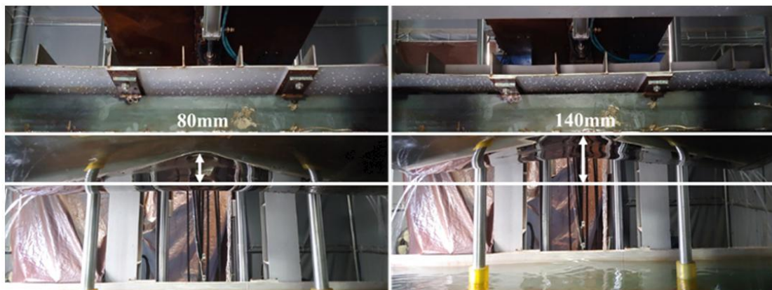
그림 7.8 첫 번째 자유 낙하 실험(좌)에서의 변형 및 다섯 번째 자유 낙하 실험(우)에서의 영구 변형
