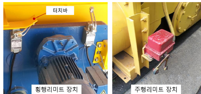
[Figure 19] 횡행 및 주행리미트(traversing and travelling limiter) (이용석, 2019)
