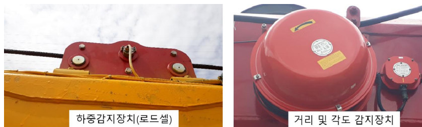
[Figure 17] 이동식크레인 과부하방지장치(moment limiter) (이용석, 2019)
