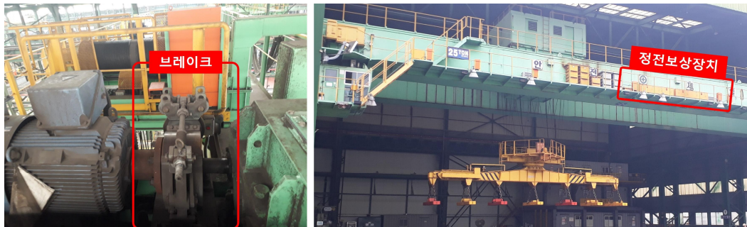
(a) 권상 브레이크 (b) 마그네트 크레인(magnet crane) [Figure 31] 페일 세이프 적용 사례
