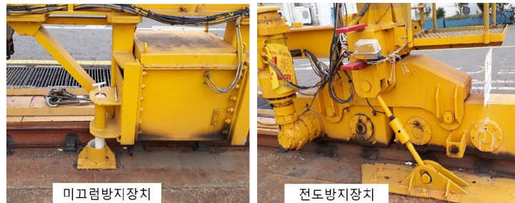
[Figure 23] 크레인 고정장치(anchor) (이용석, 2019)
