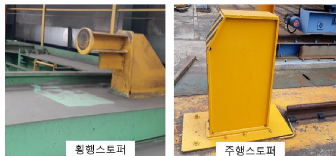
[Figure 20] 횡행 및 주행스토퍼(stopper) (이용석, 2019)
