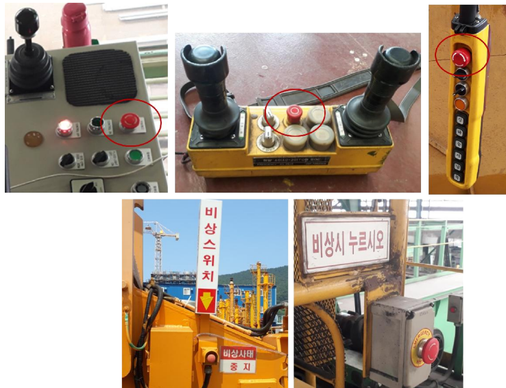
[Figure 28] 일관성 원칙이 적용된 비상정지장치
