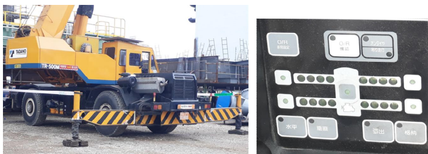
[Figure 18] 이동식크레인의 아웃트리거 설치와 감지장치 (이용석, 2019)
