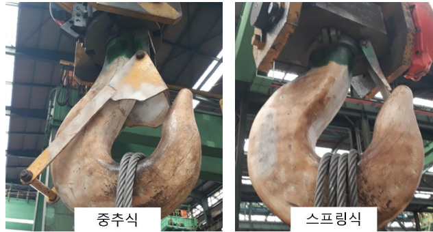
[Figure 21] 혹 해지장치(safety latch) (이용석, 2019)
