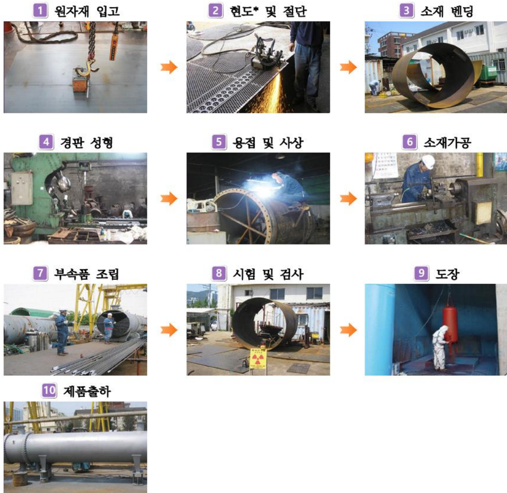
그림 II-3. 냉동기 및 압력용기 제조의 일반적인 생산공정(고용노동부&안전보건공단, 2023d)
