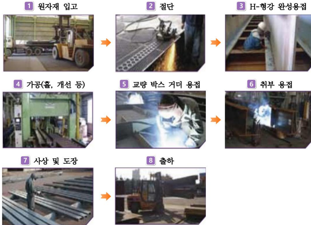
그림 II-2. 금속 가공제품 제조업의 일반적인 생산공정(고용노동부&안전보건공단, 2023b)
