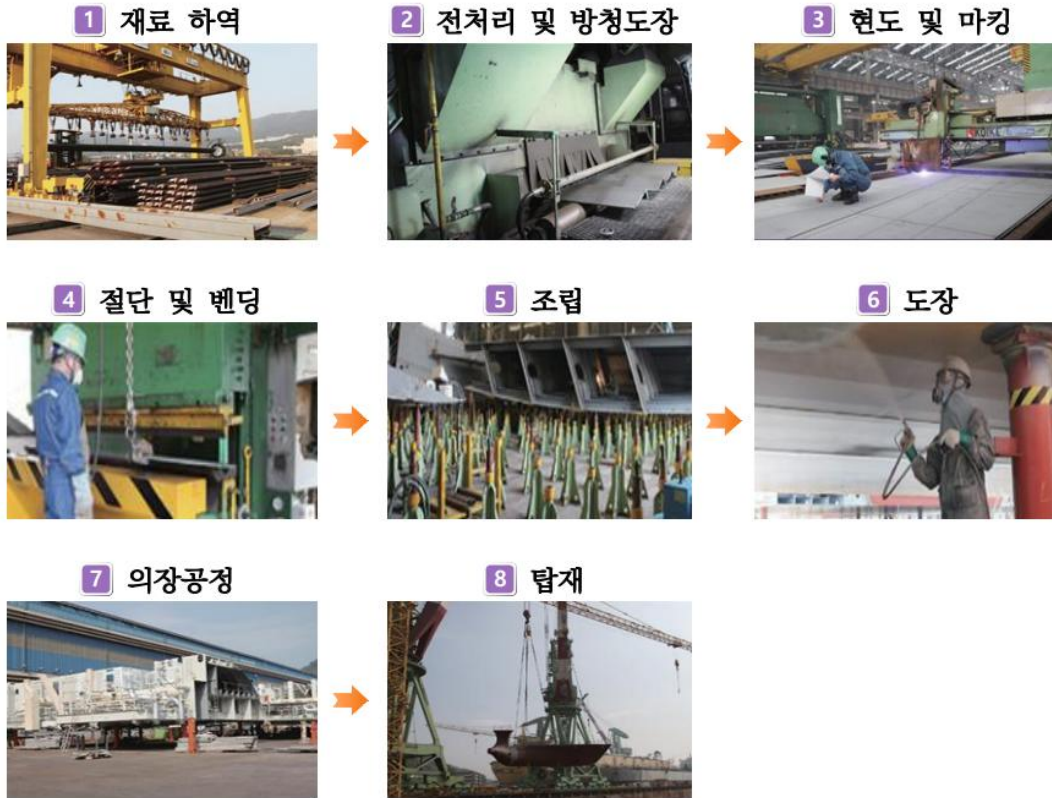
그림 II-4. 기타 운송장비 제조업 중 강선 건조업의 일반적인 생산공정(고용노동부&안전보건공단, 2023a)
