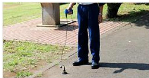
(b) 청음식 누수탐지기를 이용한 방법
