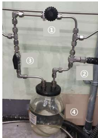
[그림 3-4] 가습장치 (① 니들밸브 ② 마이크로 니들밸브 ③ 볼밸브 ④ 밀폐수조)(김용태 & 정기호, 2022).
