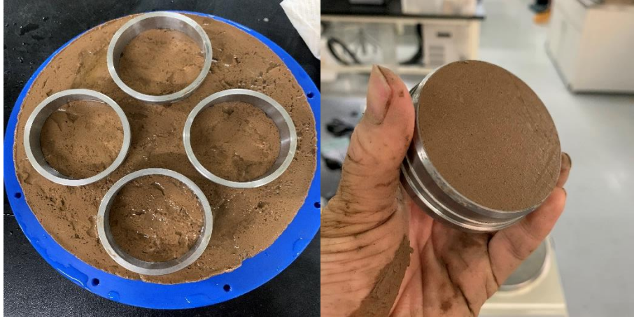
그림 3.2 포화된 시료를 압밀링에 넣는 모습
