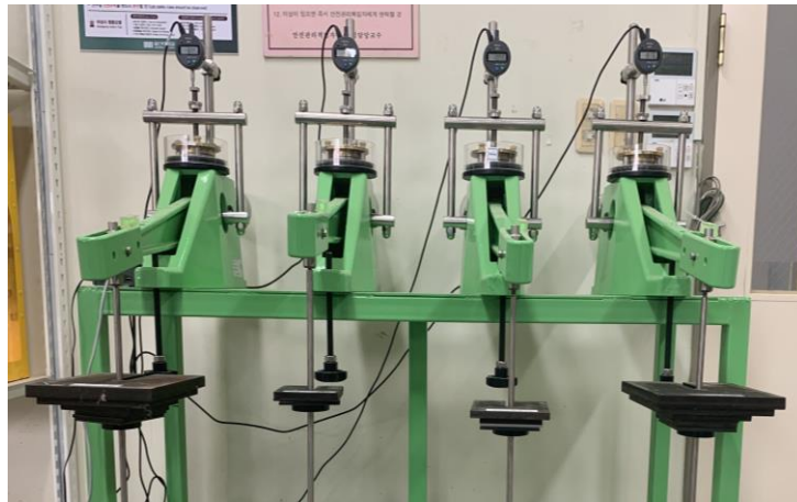
그림 3.3 압밀 시험기에 하중을 가하는 모습
