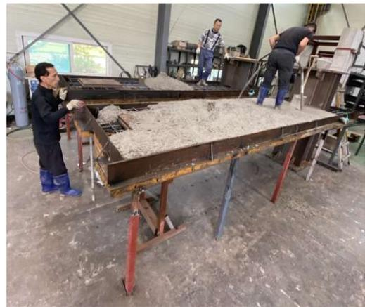
그림 4.4 실험체 게이지 설치 및 타설
