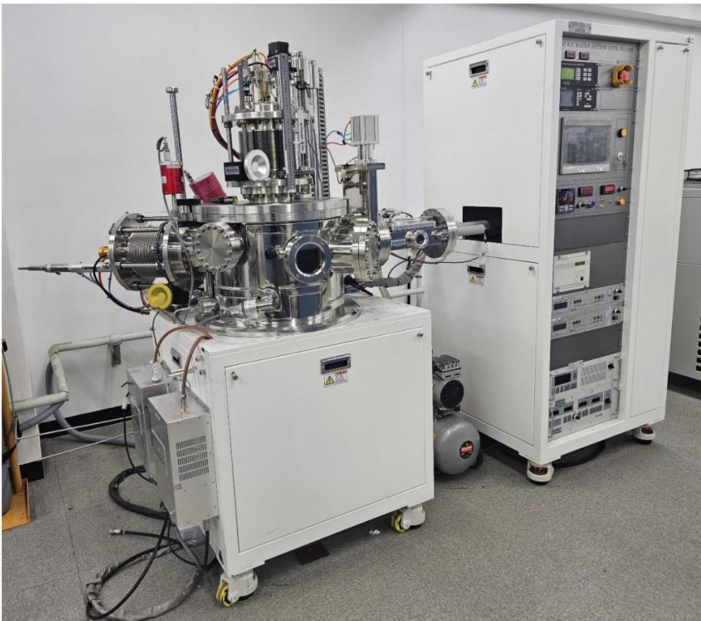
Fig. 3-1 RF & DC Magnetron Sputtering System(마그네트론 스퍼터링 장비)
