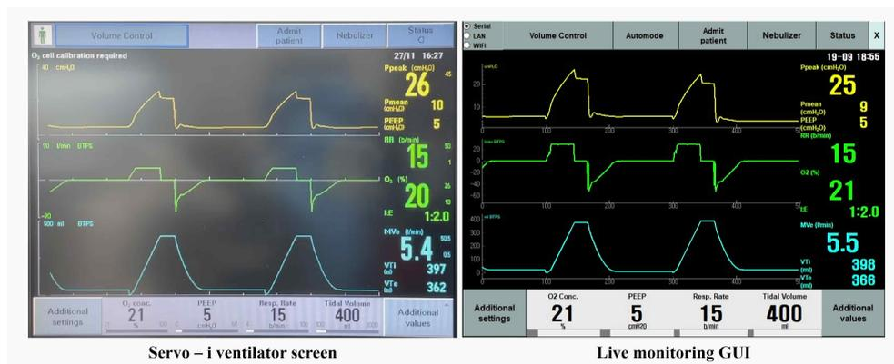
그림 15 인공호흡기 스크린과 데이터 모니터링 시스템 GUI 비교
