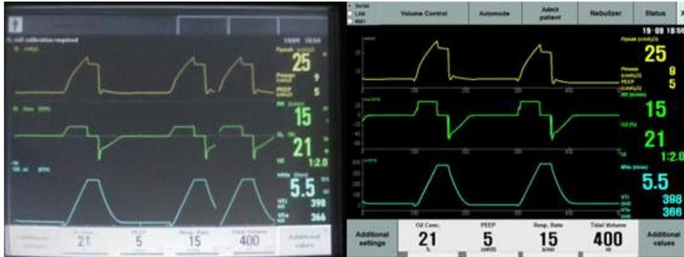
그림 18 인공호흡기 통합 모니터링 시스템 GUI
