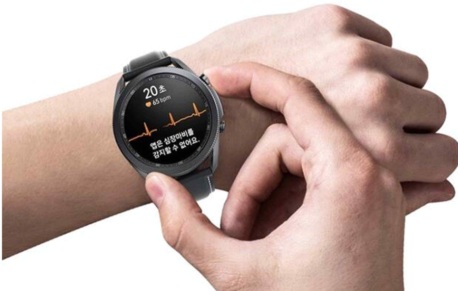
그림 5. 스마트 워치 심전도 측정 방법
