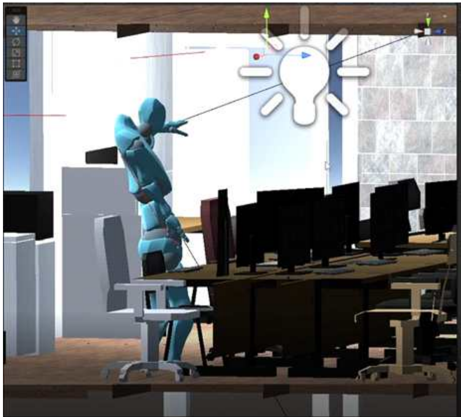
(b) 팔의 방향으로 Ray를 발생해 상호작용 발생 그림 3.6 디지털 트윈에서의 상호작용 발생 과정
