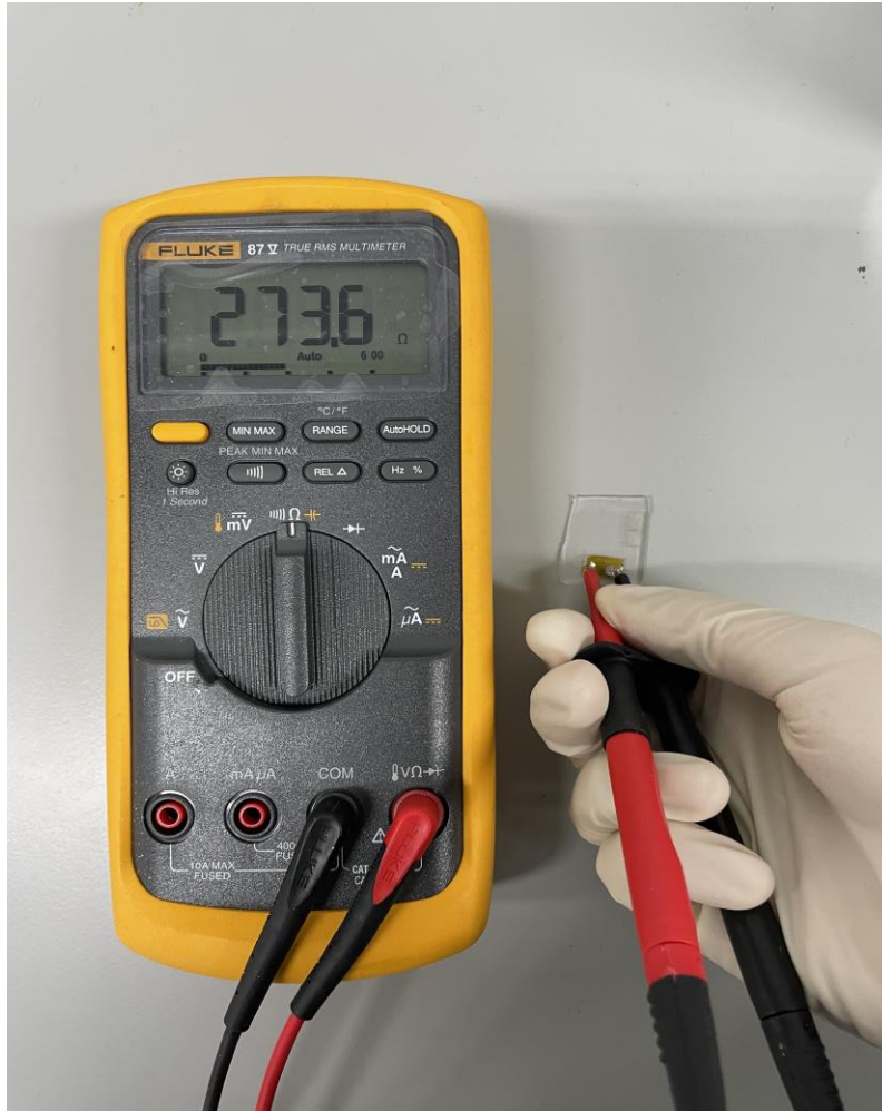
그림 3-5. 디지털 멀티미터를 이용한 마이크로 히터 전기저항 측정
