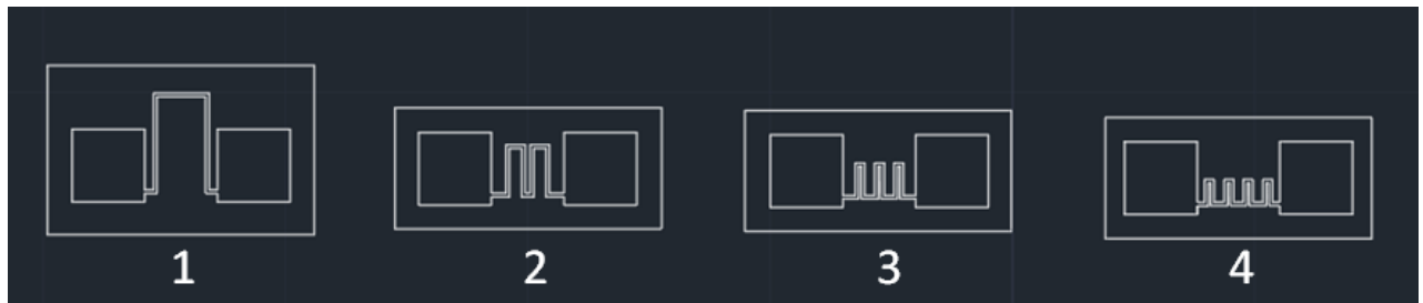
그림 4-19. 나선형구조를 1 회부터 4 회까지 반복한 meander 회로
