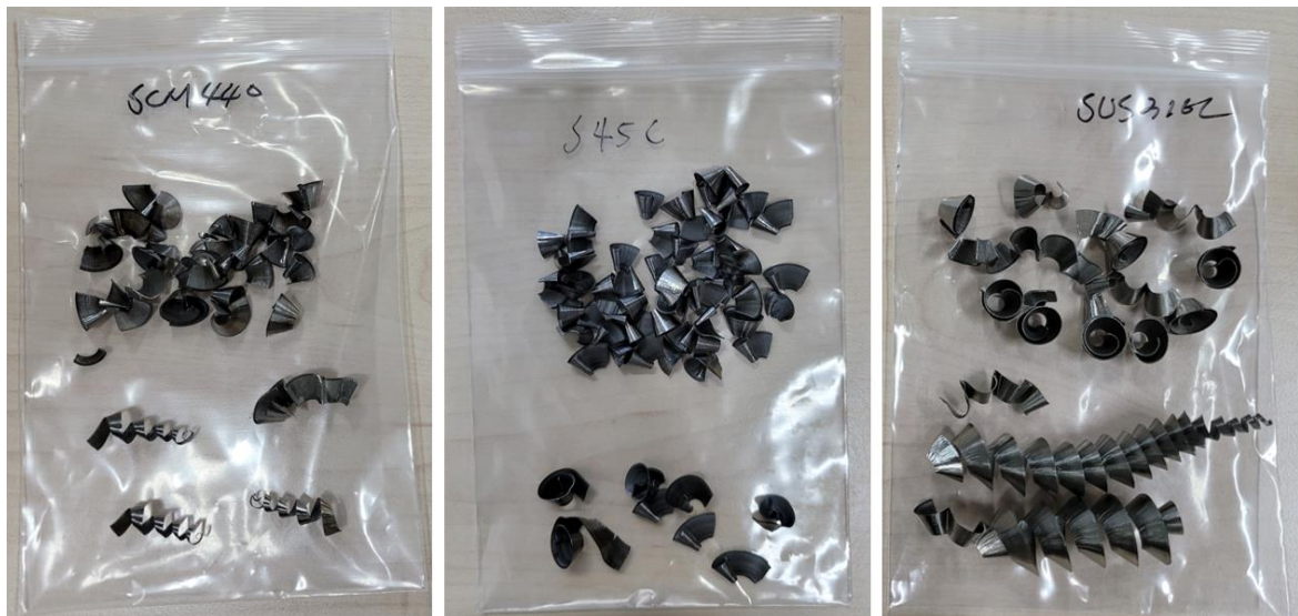
그림 3-15. SCM440, SM45C, STS316L 가공 시 칩 길이 차이
