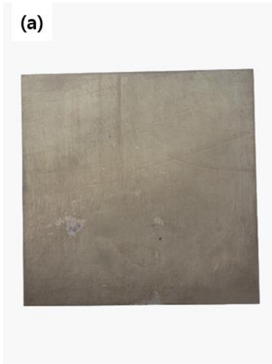
그림 4-3. (a) 열처리 후 시편, (b) 2차 평삭 가공 후 시편
