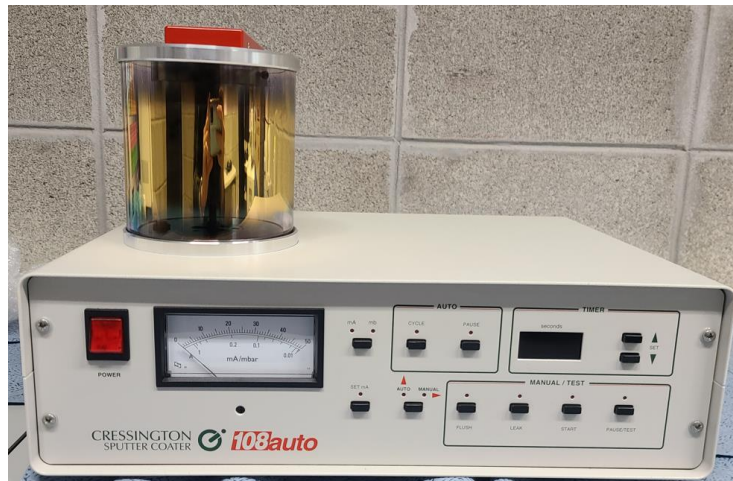
그림 4-10. Au 코팅용 Sputter coater
