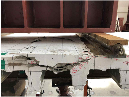
(c) 좌측 가력점 슬래브 후면 균열
