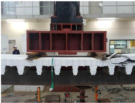
(c) 중앙부 정면 콘크리트 슬래브 균열
