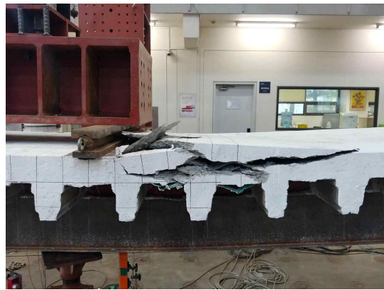
(d) 우측 가력점 슬래브 정면 균열
