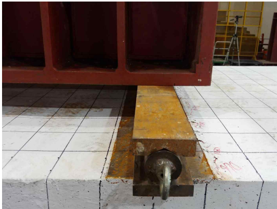
(e) 우측 가력점 슬래브 정면 균열
