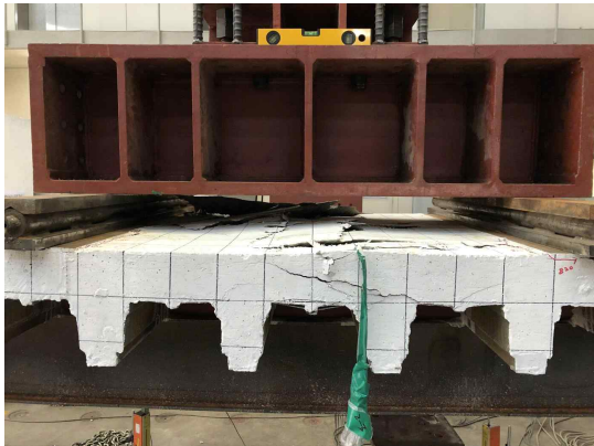
(c) 중앙부 콘크리트 슬래브 정면 균열
