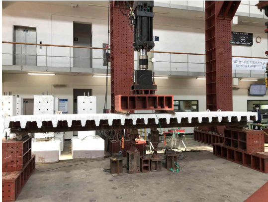
(a) 실험체 설치
