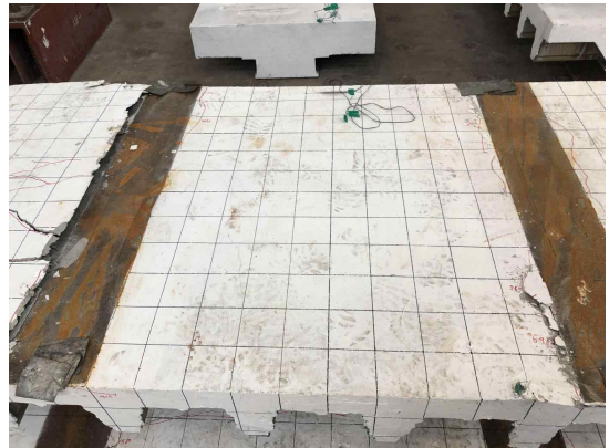
(d) 중앙부 콘크리트 슬래브 균열
