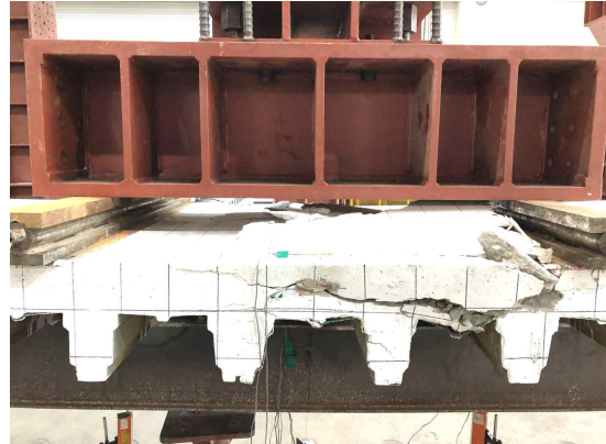
(d) 중앙부 콘크리트 슬래브 후면 균열
