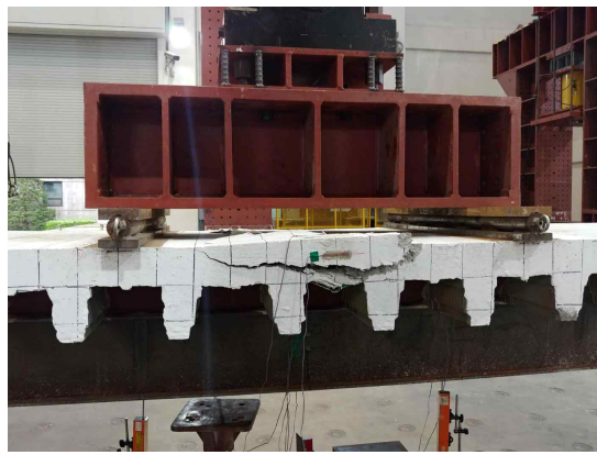
(d) 중앙부 가력점 슬래브 후면 균열
