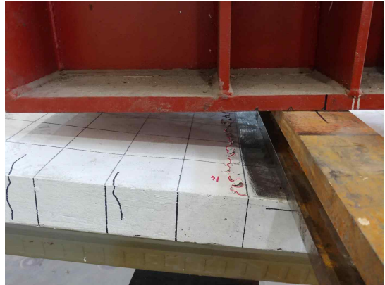
(d) 우측 가력점 슬래브 후면 균열
