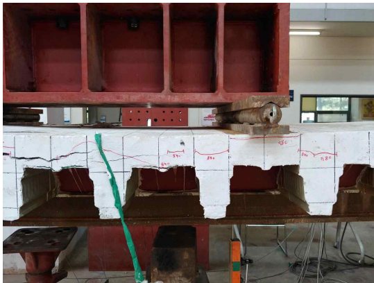
(e) 우측 가력점 슬래브 정면 균열
