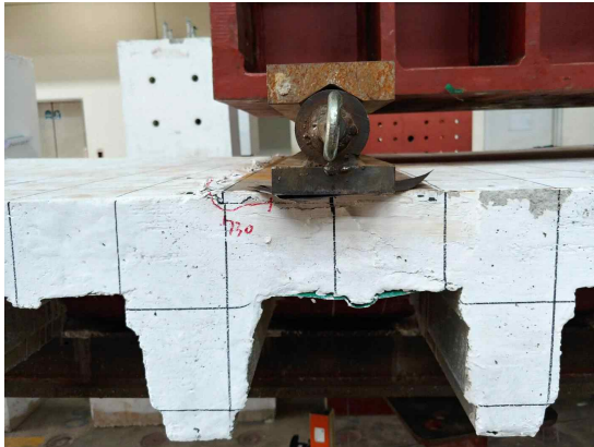
(e) 좌측 가력점 슬래브 정면 균열
