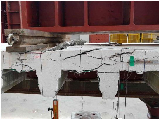
(c) 우측 가력점 슬래브 후면 균열
