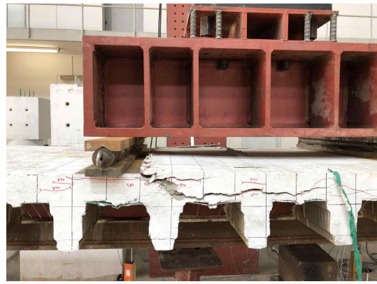
(b) 좌측 가력점 슬래브 정면 균열
