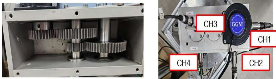
[그림 39] 기어 박스 내부 구조 및 센서 설치 위치
