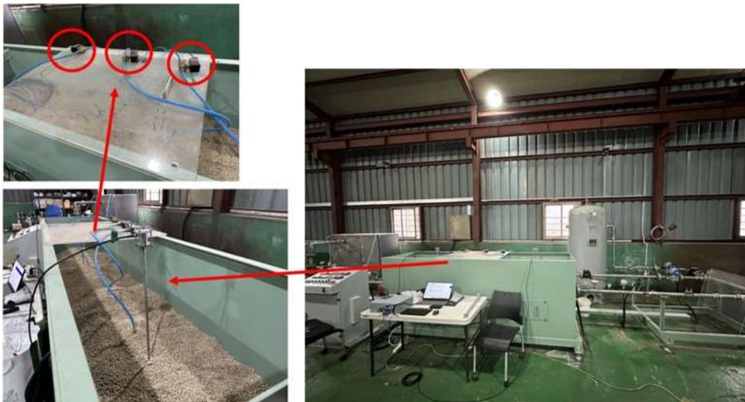
[그림 31] 산업용 지하배관 결함모사 테스트베드
