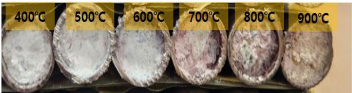
Figure 16. 백동 Pipe 내 Silica 내화재의 온도별 소결 시험편
