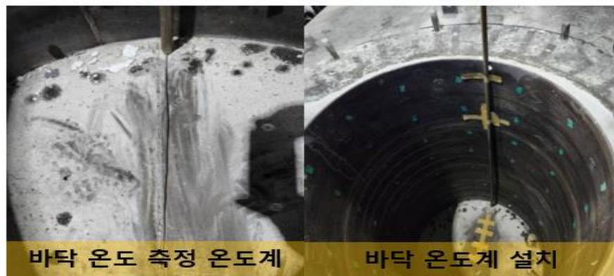
Figure 21. Silica 내화재를 측로한 Coreless Furnace 바닥온도계
