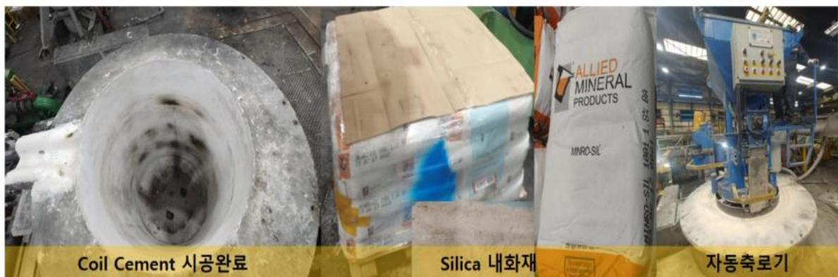
Figure 18. 양산형 Coreless furnace 축로
