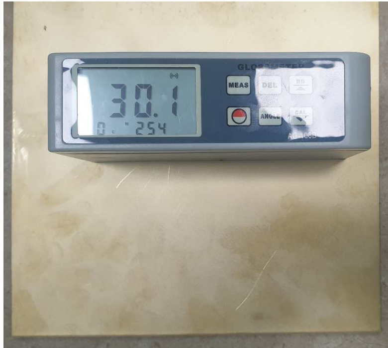
[Figure 24] Amittari사의 'AG-106B gloss meter' 를 이용한 황동 시편의 광택도 측정
