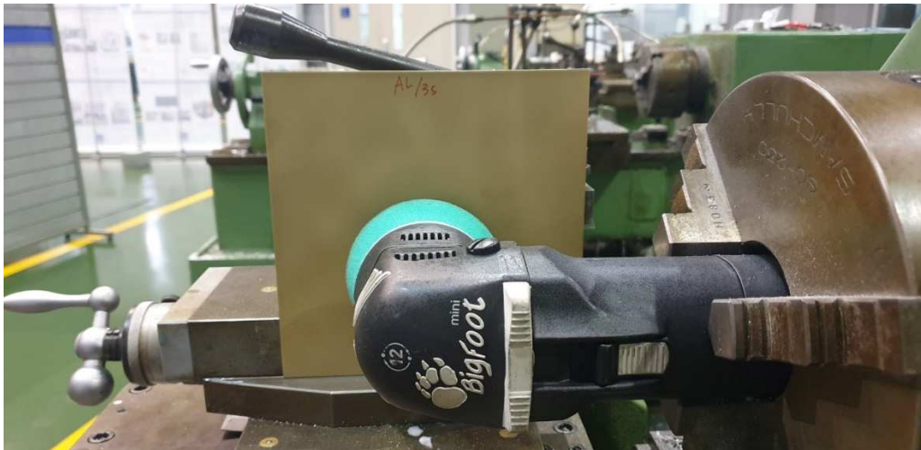
[Figure 19] 표면거칠기 측정을 위한 실험 세팅
