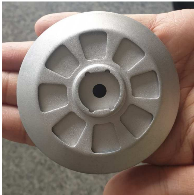
[Figure 18] 100시간 작업 후의 고내식 마그네슘 합금 백킹플레이트 사진
