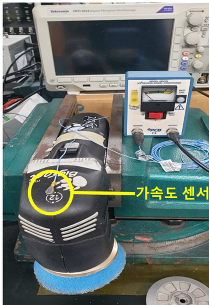
[Figure 27] 가속도센서를 이용한 듀얼액션광택기의 진동 측정
