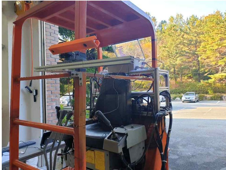
Fig. 4-2 굴착기의 카메라 시스템
