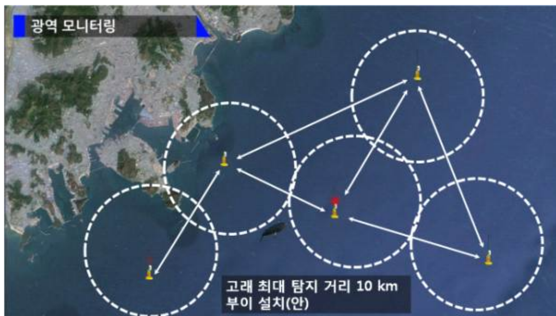
그림 4. 고래 모니터링 부이 설치(안)
