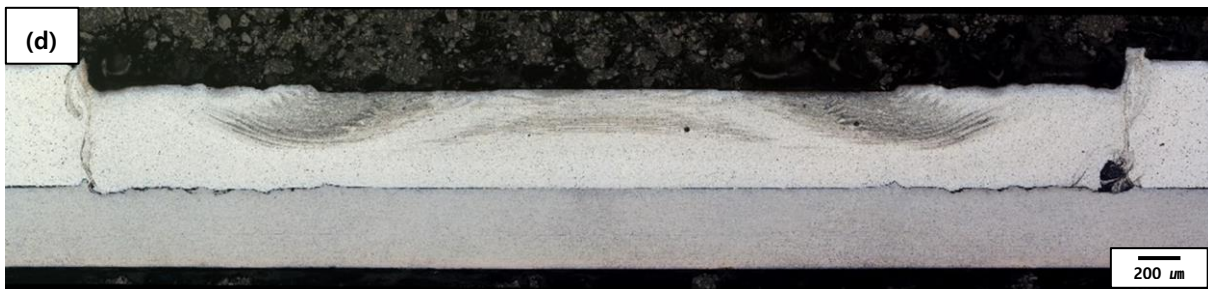
그림 4-8 삽입 깊이에 따른 단면: (a) 0.6 mm, (b) 0.7 mm, (c) 0.8 mm, (d) 0.9 mm
