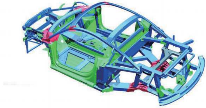
그림 3 2013 AUDI A8 알루미늄 차체에 적용된 알루미늄합금 주조재 [11]
