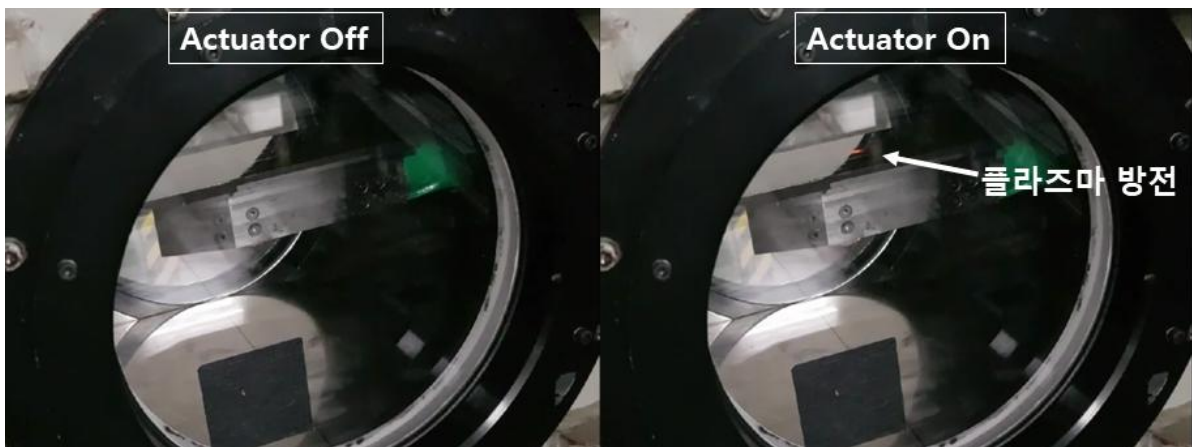
그림 40 스파크제트 액츄에이터 플라즈마 방전 시험부 그림 (동영상 캡처)
