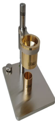
그림 3.4 Hall Flow Meter 의 사진과 측정 방법
