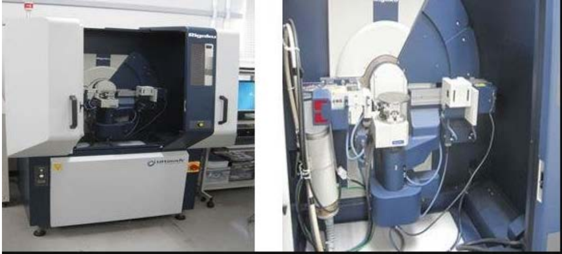
그림 3.3 분말 분석에 사용된 XRD 장비
