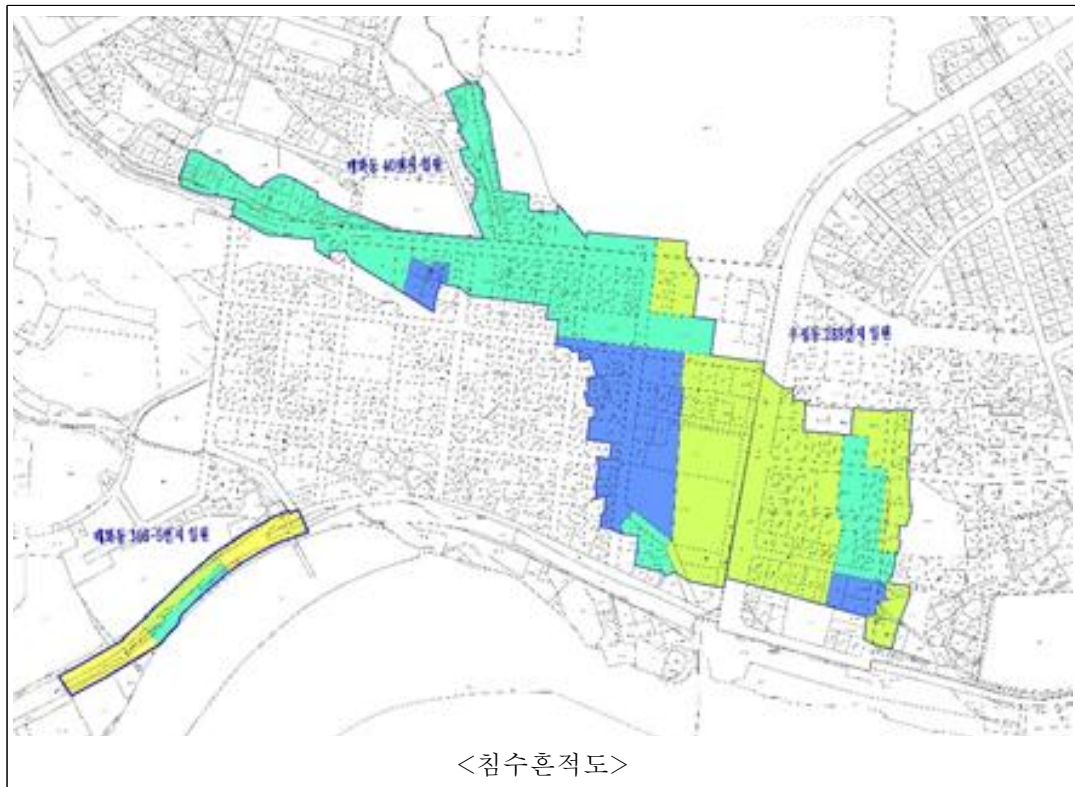
그림 4.3 태화우정시장유역 침수해석 결과 및 침수흔적도(계속)
