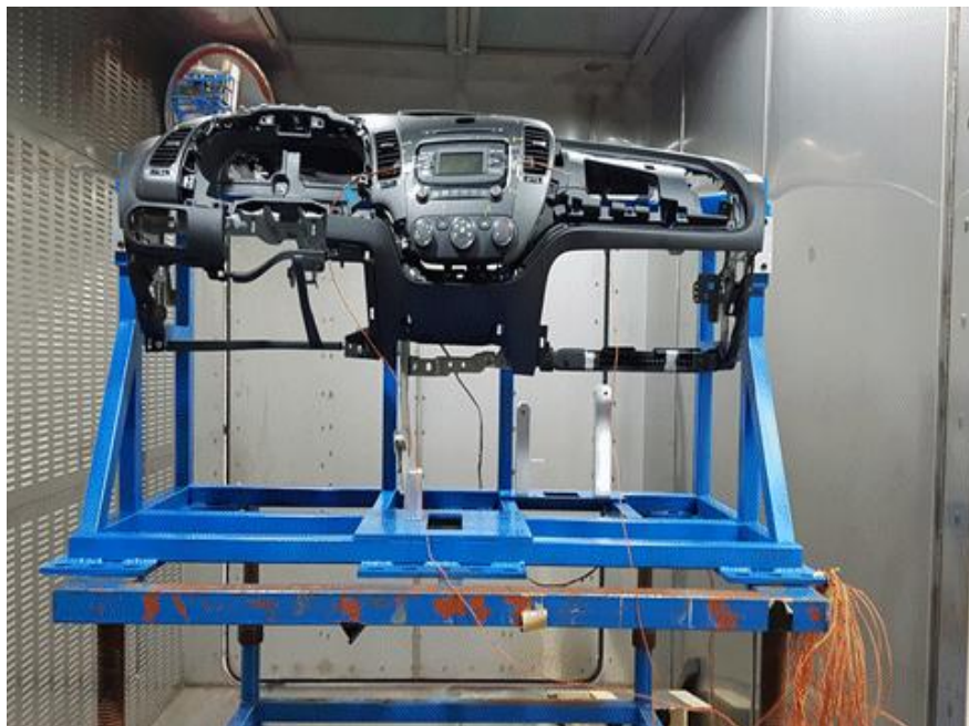
그림 5.10 시험품 복합환경시험 셋업
