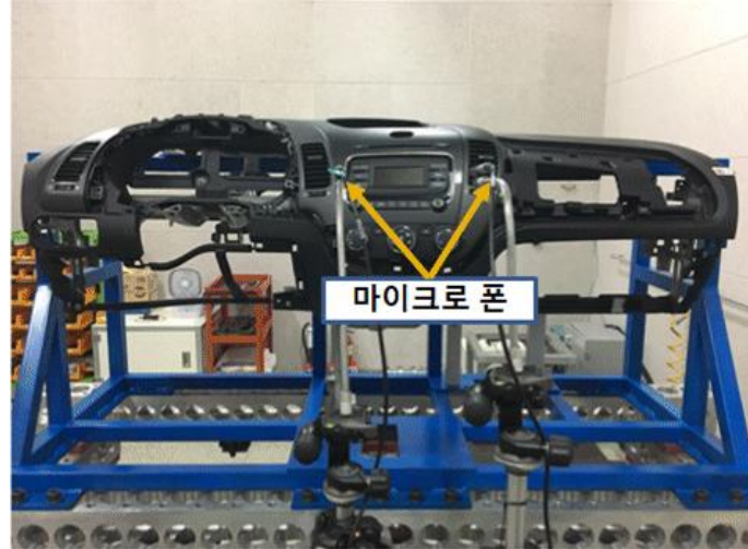
그림 5.12 진동에 의한 소음 측정 셋업
