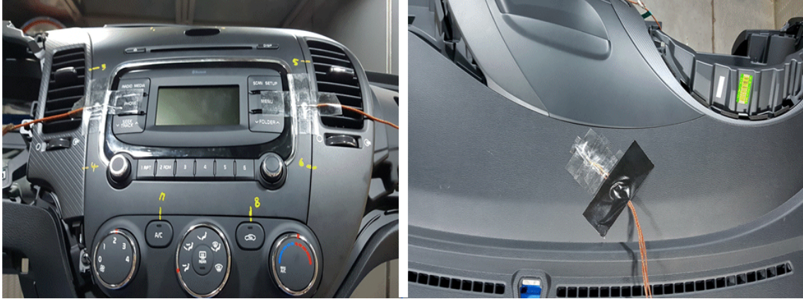
그림 5.11 온도 센서 설치
