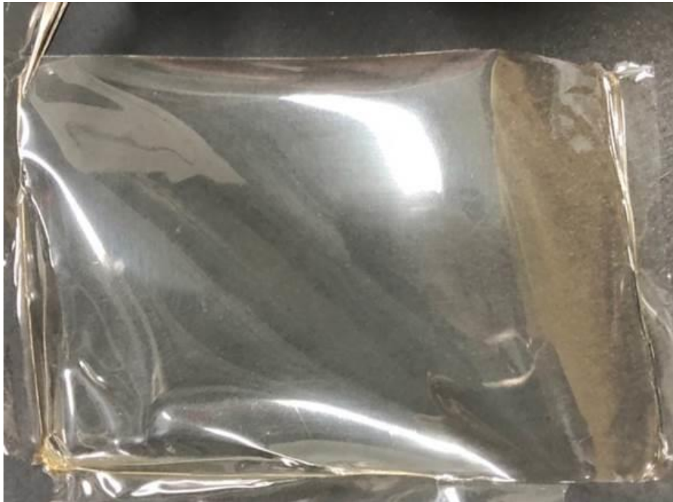
그림 4-16. 속신산 무수물 개질 셀룰로오스 100 패스 Freestanding Film
