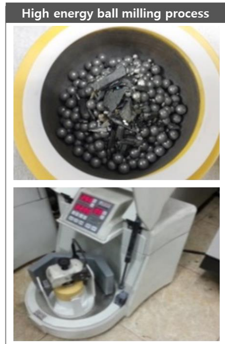
그림 3.3. EOG/BTS(Cu) 열전 필름 제작 흐름도
