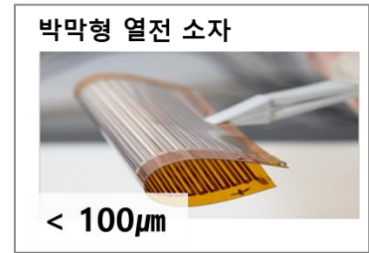
그림 2.5. 열전 소자(Thermoelectric element)의 종류
