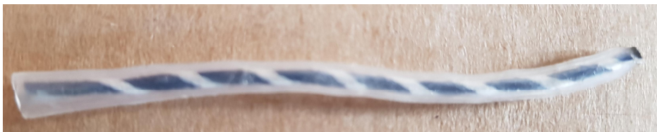
[그림2.5] 탄소섬유 횡건 및 Teflon Coating
