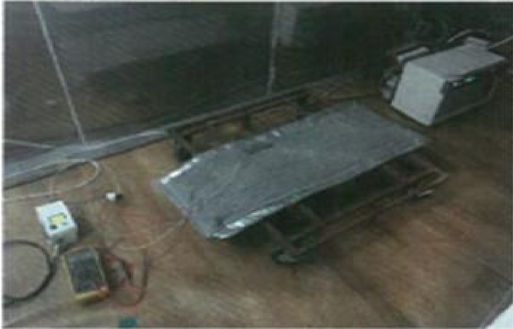
[그림4.37]탄소섬유 히터 테스트
