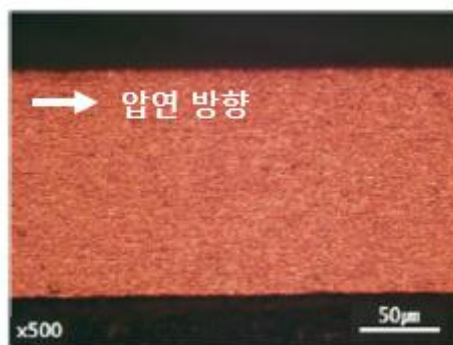
Fig 3.17. 380도 열처리 후 조직 사진
