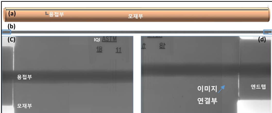
[그림 6] 디지털 방사선투과검사 이미지(a) 용접 강관, (b) 방사선투과검사 이미지 (전 길이), (c) & (d) 양쪽 관단 방사선투과검사 이미지
