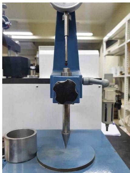
그림 3.2 Fall cone test 장비
